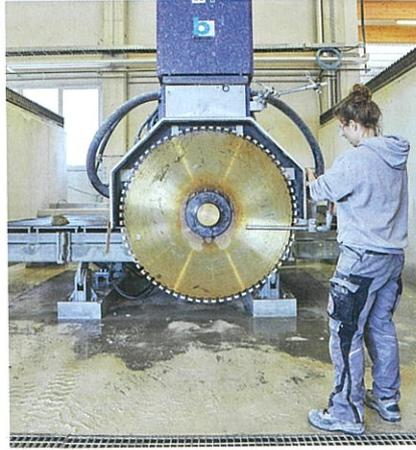
Für Arbeiten in der Denkmalpflege ist eine ausreichend dimensionierte Z-Achse Voraussetzung.
